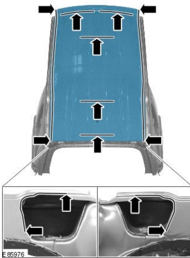
3. 向上提起新的面板和夹子直至到位。检查定位，如果正确，继续下一步；如果错误，纠正并在继续前重新检查。
