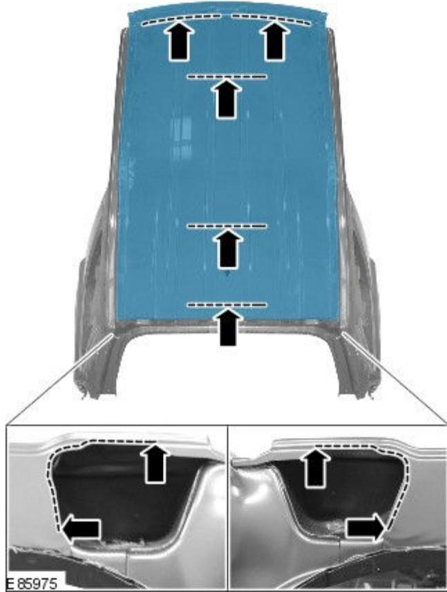
15. 隔离固定接头并卸下旧面板。
